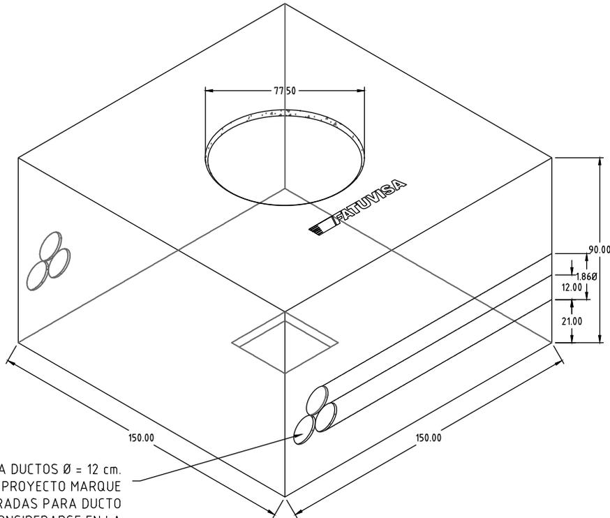
ORIFICIOS PARA DUCTOS  $\varnothing = 12 \text{ cm}$ .
